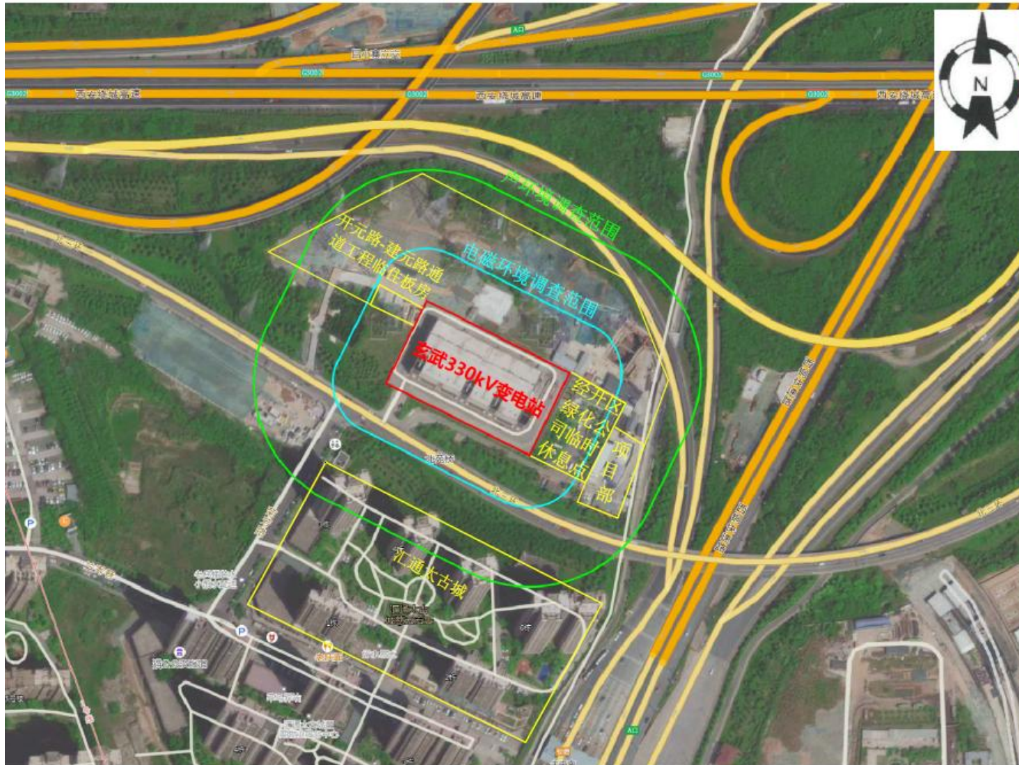
图 2.6-1 玄武 330kV 变电站位置关系示意图
