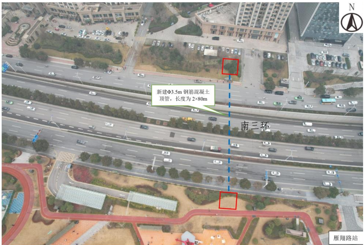
雁翔路地铁站预留通道
