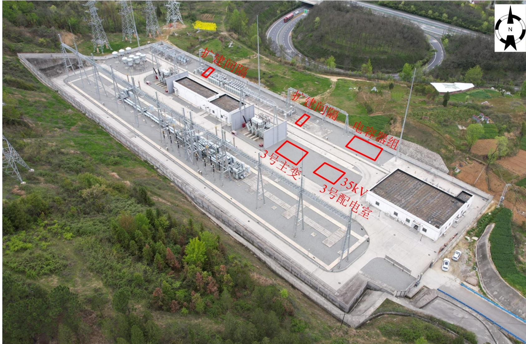
图 3.3-2 月河 330kV 变电站本期扩建工程站内位置
