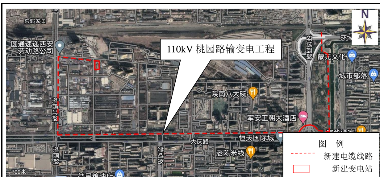
图4-5 110kV桃园路输变电工程路径图
