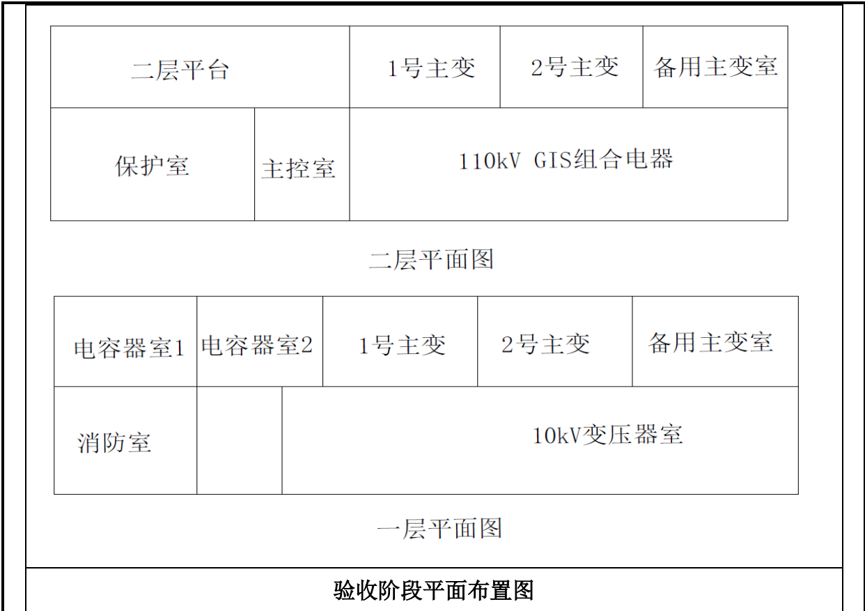
图4-3 110kV桃园路变电站平面布置示意图
