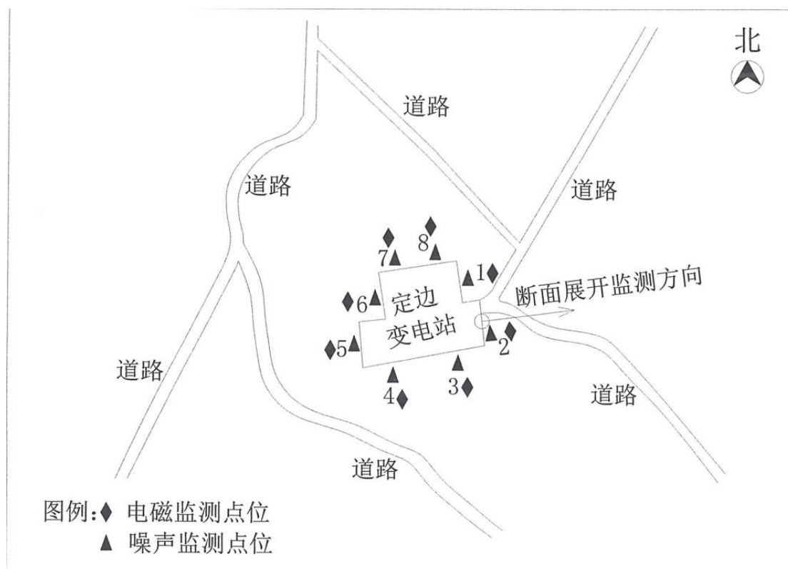
图 7-1 定边 330kV 变电站扩建工程竣工环保验收检测点位示意图
